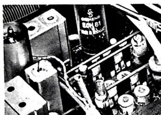
Blick auf die direkt auf der Druckplatte befestigten Messerkontakte der Drucklastenschalter (Blaupunkt)
